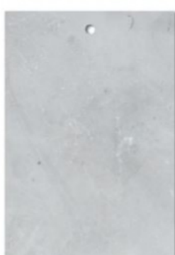
Stal ocynkowana ogniowo
