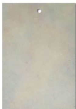
Stal ocynkowana galwanicznie
